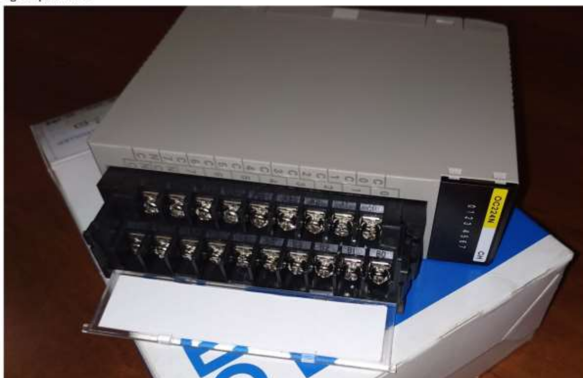
OMRON C-200 C200H-OC224N Moduł wyjść dwustanowych 8 x przekaźnik Egzemplarz nr 1
