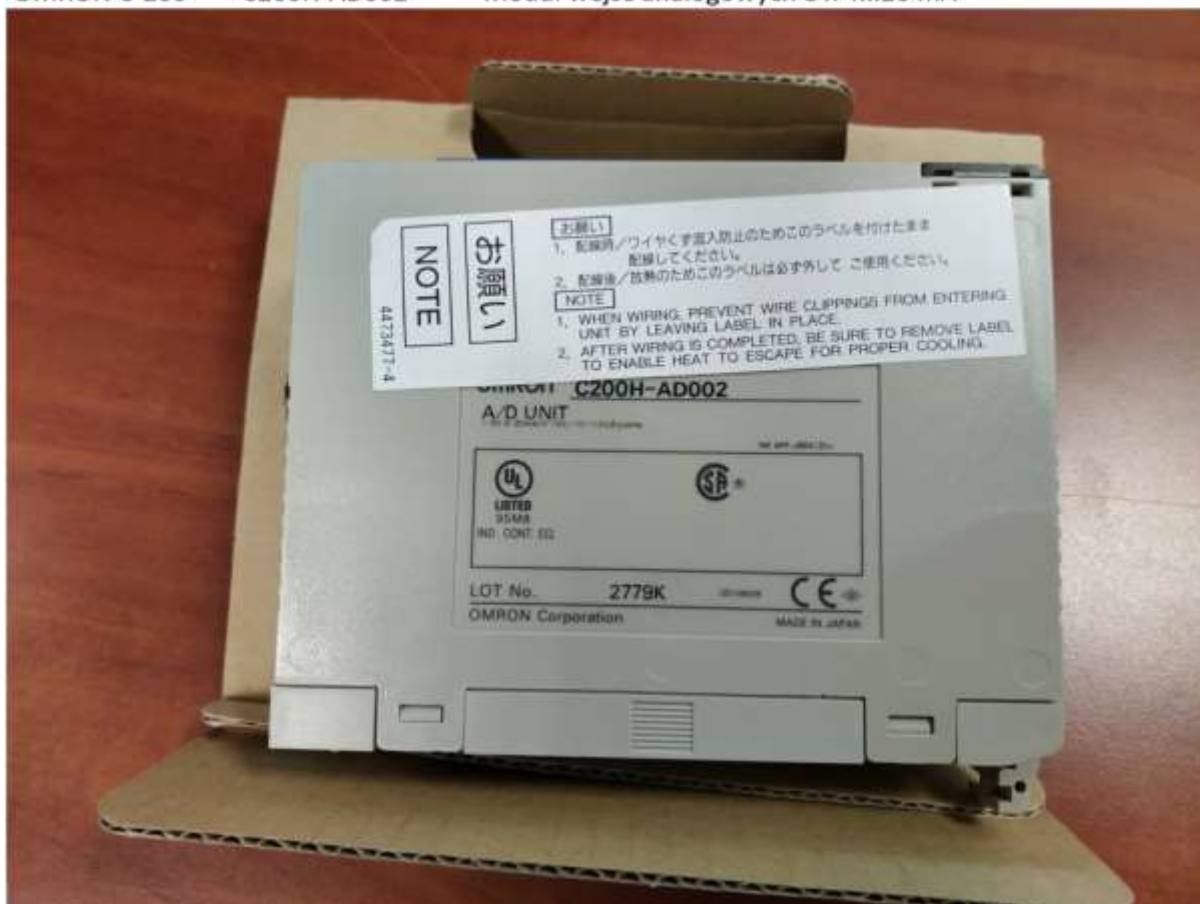
OMRON C-200 C200H-AD002 Moduł wejść analogowych 8 x 4...20 mA
